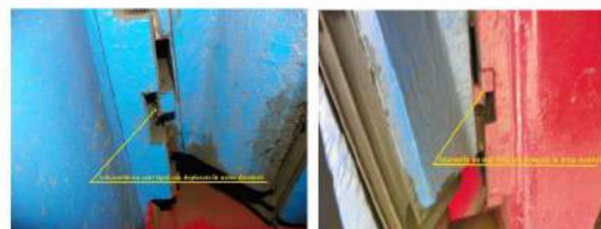
Foto 7: Adaosuri metalast roată osia 6 partea stângă sens de mers – față
