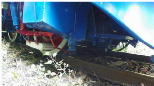
Foto 1. Poziția locomotivei EA 130 după deraiere
