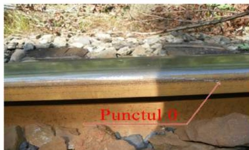
Foto 2. -Prima urmă de escaladare a feței active a ciucercii șinei
